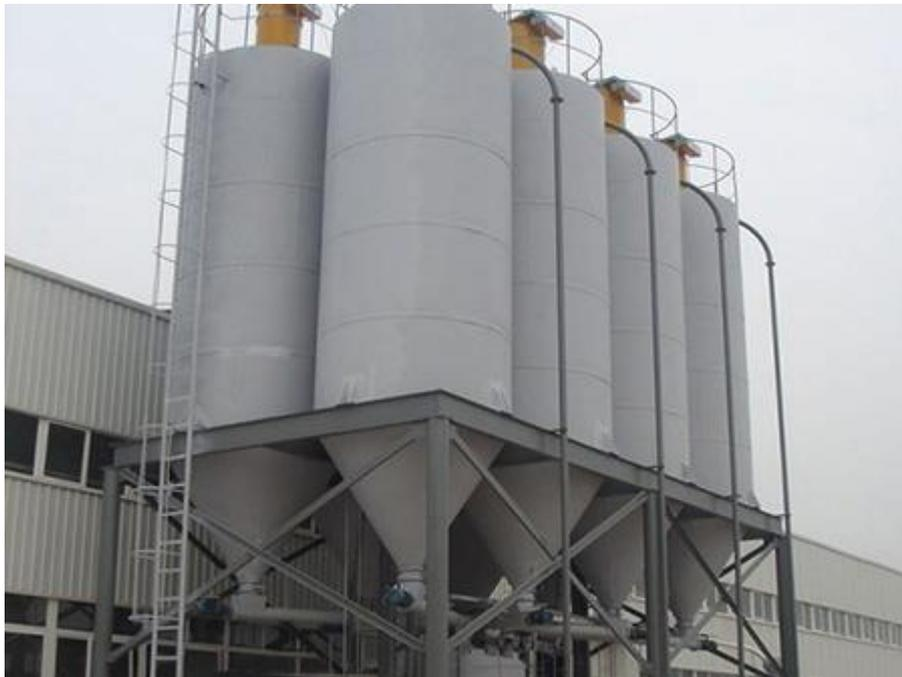
Силосы и бункеры предназначены для хранения и выгрузки сыпучих материалов. Представляют собой вертикальные емкости круглого или прямоугольного сечения.
